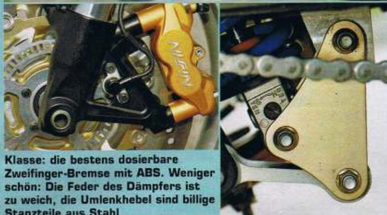
**Klasse:** die bestens dosierbare Zweifinger-Bremse mit ABS. Weniger schön: Die Feder des Dämpfers ist zu weich, die Umlenkhebel sind billige Stanzteile aus Stahl
