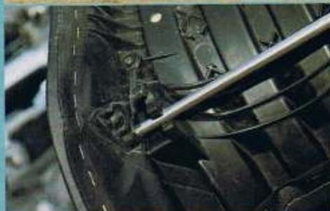
**Pfiffig und gut:** Die Sitzbank lässt sich über eine Stange zweifach in der Höhe variieren, das Federbein wird durch eine Plastikabdeckung vor Verschmutzung geschützt
